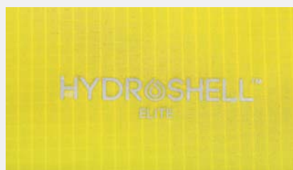
ハイドロシェルはバグハウスの独自素材。表地に防水透湿メンブレンをラミネートし、保護層を加えた2.5レイヤー
