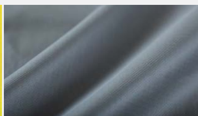
ハイドロシェルはバグハウスの独自素材。表地に防水透湿メンブレンをラミネートし、保護層を加えた2.5レイヤー
